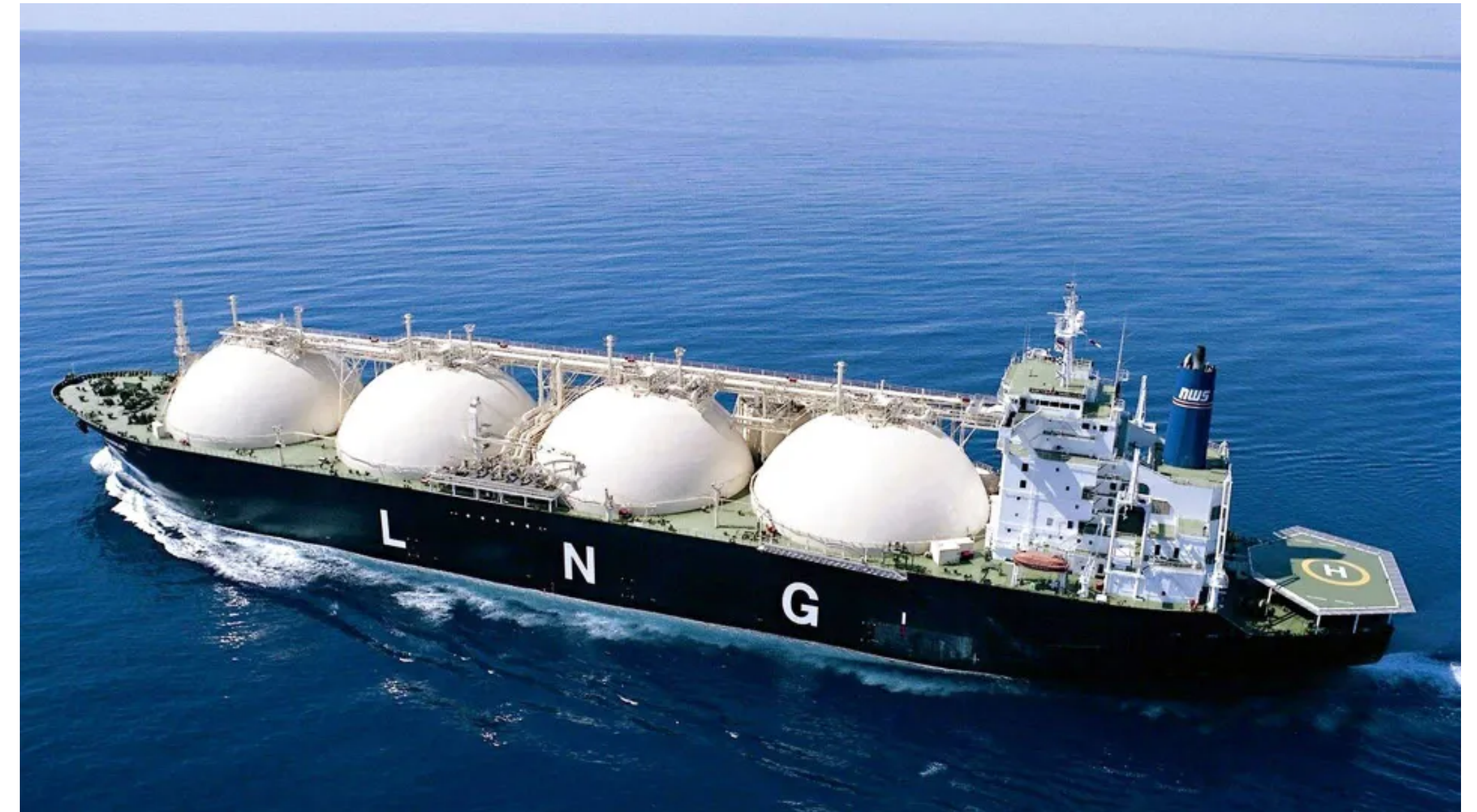
Typical $200 million LNG tankship LNG liquid at -160^{\circ}\text{C}
